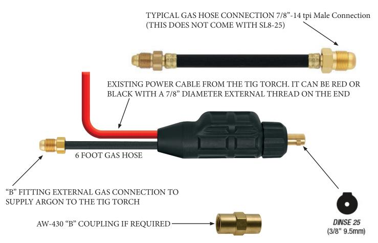
THE SL8-25 IS AN EXTERNAL GAS AND POWER CABLE CONNECTOR. **YOU NEED TO KNOW HOW THE GAS IS GOING TO GET TO THE TIG TORCH.**
