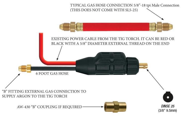
THE SL5-25 IS AN EXTERNAL GAS AND POWER CABLE CONNECTOR. **YOU NEED TO KNOW HOW THE GAS IS GOING TO GET TO THE TIG TORCH.**
